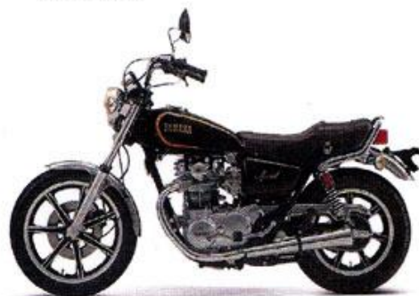
Yamaha XS 650 Special är enda versionen som har skivbroms bak.
